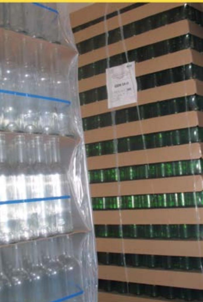
Le film industriel gaine **DIPACK** est fabriqué à base de polyéthylène basse densité ; il est destiné au stockage et au transport des produits sur palette. L'utilisation des housses rétractable remplit plusieurs objectifs. Le film industriel gaine **DIPACK** présente des performances accrues en termes de rigidité, de rétractabilité, de résistance au fluage, de scellabilité et de potentiel d'amincissement.
